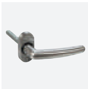
Maniglia con mostrina ovale, piastrine di adattamento e quadro maniglia 8 mm (lungo 13 cm accorciabile a piacere)
