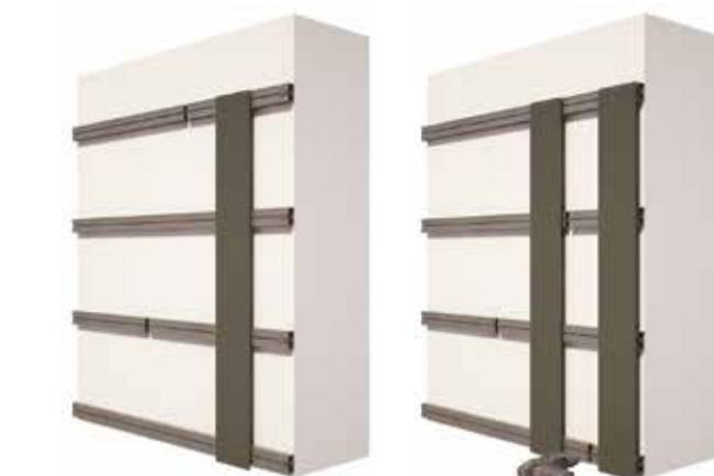
Dopo aver fissato i magatelli usare la clip start usando clip cod. AF602 per fissare la prima dogha, poi continuare l'installazione usando la clip cod. AF601.
