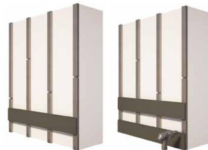
Dopo aver fissato i magatelli usare la clip start usando clip cod. AF602 per fissare la prima doga, poi continuare l'installazione usando la clip cod. AF601.
