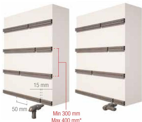
Installare i magatelli in alluminio in una superficie regolare e liscia. Rispettare le distanze come da disegno.
