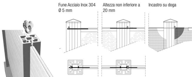
Per recinzioni più alte di 2000 mm, in special modo se si trovano in aree ventose: consigliamo l'inserimento di un morsetto con fune in acciaio nel canale interno della doga, per rinforzare ulteriormente la tenuta della recinzione evitando che il vento vada a rompere le doghe.
