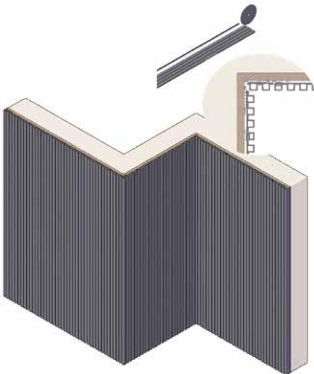
Tagliare a misura l'ultima doga e fissare con le viti. Prima di fissare le viti si deve sempre preforare il Wpc.
