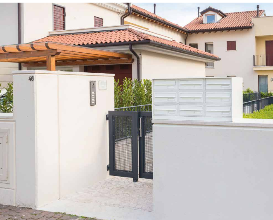
Casellare posto su muretto di recinzione composto da cassette serie Open Air, modello SC3 verniciate bianco RAL
