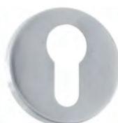
1501 Y: bocchetta tonda D.50x10mm con foro yale
