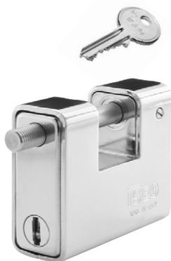
Lucchetto RETTANGOLARE BOXER, **CORAZZATO SU TUTTI I LATI**, per serranda. Corpo in zama contenuto in una corazza in acciaio carbonitrurato e cromato da mm 90. Funzionante con monocilindro a profilo europeo **F5** da mm 40 (30+10) camma sporgente art. 820930107 in dotazione. Stelo in acciaio INOX da Ø 12, zigrinatura per apertura. Bloccaggio stelo con sfera. **LUCE STELO mm 36X17,5**.
