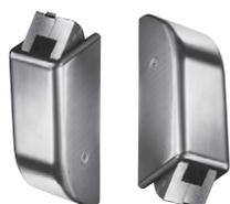
Coppia scrocchi finitura in PVD per antipanico "IDEA Base PVD - Inox". Chiusura verticale alto e basso. Scrocco in acciaio con autobloccante, idoneo per porte TAGLIAFUOCO. Incontri 94100112+94100127. Viti di fissaggio.
