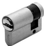
Cilindro R11 Progress MONOPROFILO. Chiave piatta in alpaca a **11 perni**, con medaglia plastificata. **RESISTENTE AL BUMPING**. Protezione antitrapano nel corpo cilindro e nel cilindretto. Camma DIN 8 posizioni. Perni di cifratura in acciaio inox. Barra antistrappo. **5 CHIAVI. CODE CARD**. Vite di fissaggio.
