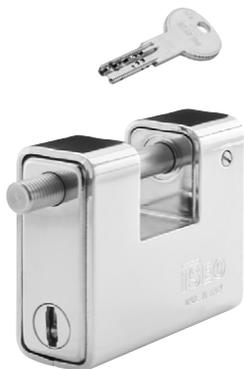
Lucchetto RETTANGOLARE BOXER, **CORAZZATO SU TUTTI I LATI**, per serranda. Corpo in zama contenuto in una corazza in acciaio carbonitrurato e cromato da mm 90. Funzionante con monocilindro a profilo europeo R7 da mm 40 (30+10) camma sporgente art. 82R7030109 in dotazione. Stelo in acciaio INOX da Ø 12, zigrinatura per apertura. Bloccaggio stelo con sfera. **LUCE STELO mm 36X17,5.**
