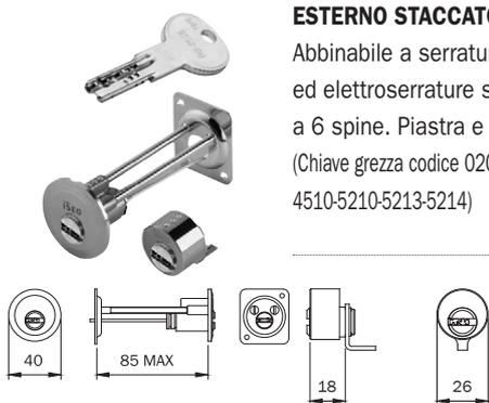
Coppia cilindro R6 **INTERNO** da applicare alla serratura e cilindro **ESTERNO STACCATO** da applicare su porte spessore max mm 85.
