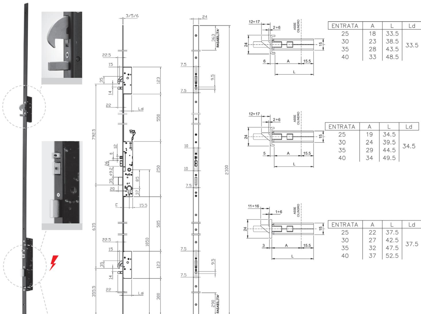
Elettroserratura MULTIPUNTO da infilare per montanti, CHIUSURA TRIPLICE,
