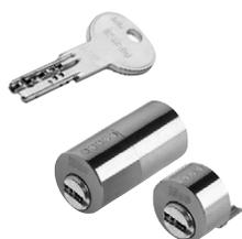
Coppia cilindro R6 **INTERNO** da applicare alla serratura e cilindro **ESTERNO FISSO Ø 26** per porte con spessore max mm 50. Abbinabile a serrature da applicare **Serie 5 52N\*** **solo scrocco**. Chiave piatta ottone nichelato a 6 spine.
