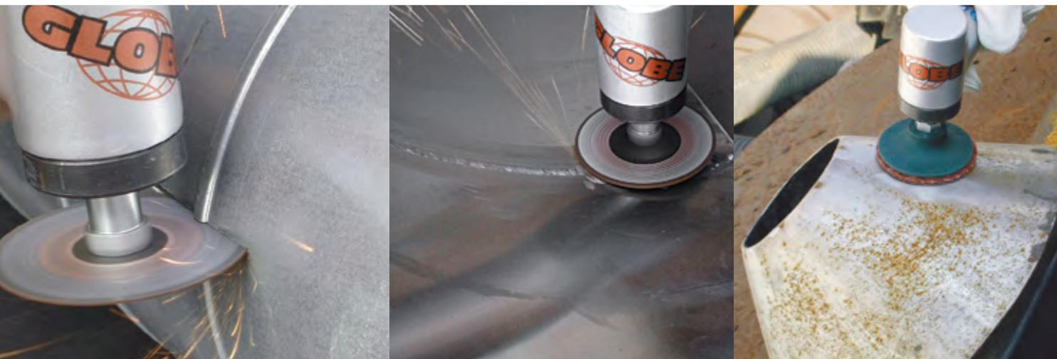
Una gamma completa di mini-dischi ( $\varnothing$  da 50 a 75mm) per il taglio, lo smeriglio e la finitura di:
