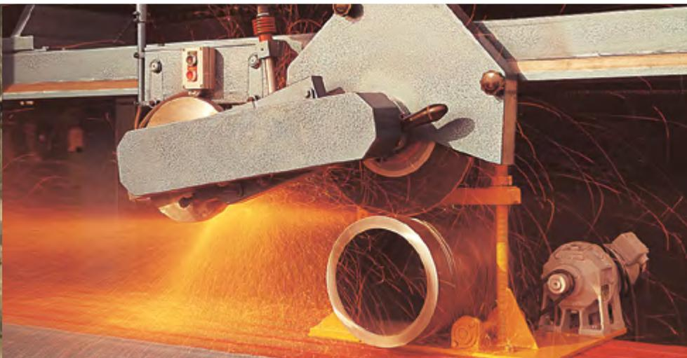
Troncatori largamente ed efficacemente utilizzati nelle fonderie sono idonei per il taglio di metalli ferrosi e non. Grazie alla forma a centro depresso, che permette di alloggiare completamente l'albero e la ghiera di fissaggio nella cavità.
