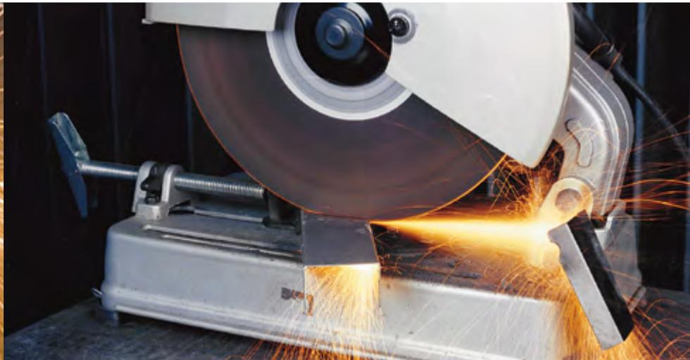
I troncatori **GLOBE** per macchine stazionarie leggere **CHOPCUT** permettono di tagliare profilati, tubi ed anche sezioni piene di pezzi aventi diametro massimo di 30/40 mm. Associano una lunga durata ad una eccezionale capacità di taglio data dal basso spessore. Particolare cura e attenzione è posta nella bilanciatura di questi dischi per garantire un taglio confortevole ed una buona stabilità della macchina senza vibrazioni.
