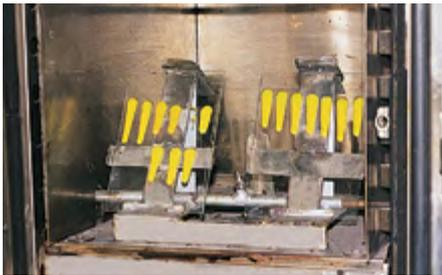
Prova di scorrimento delle resine fenoliche in polvere.
