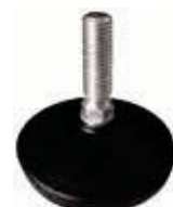
art.405 pag.21 piedino regolabile base pa e perno ferro zincocromato girevole chiave 10 levelling element pa based and zinc plated steel revolving stud mm 10
