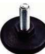
art.403 pag.20 piedino regolabile in pp con esagono ch.17 e perno ferro zincocromato pp flat levelling element with ch.17 exagon adjustment and zinc plated steel stud
