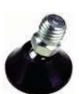
art.405 pag.21 piedino regolabile base pa e perno ferro zincocromato snodato chiave 10 levelling element pa base and zinc plated steel joints stud mm 10
