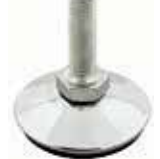
art.408 pag.22 piedino regolabile base in pa e perno ferro zincocromato girevole chiave 17 levelling element pa base and zinc plated steel revolving stud mm 17
