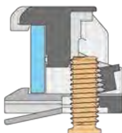
2. Montaggio dei perni nei guida asta
