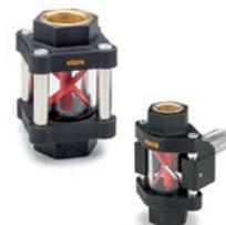
Visiera in vetro; tiranti in acciaio INOX; asse e rotore ad elica in tecnopolimero; guarnizioni in gomma sintetica NBR; boccole in ottone o acciaio INOX con filettatura gas cilindrica secondo normativa UNI ISO 228/1. Temperatura massima di esercizio: 100° C. Funzionamento con flussi bidirezionali. Filettature GAS: 1/4 - 3/8 - 1/2 - 3/4 - 1
