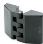
Perno di rotazione in acciaio INOX AISI 303. Montaggio mediante boccole ottone nichelato, foro filettato; prigionieri filettati in acciaio nichelato; fori passanti per viti a testa cilindrica. Angolo di rotazione: max 200° (-80° e +120° con 0° = complanarità delle superfici interconnesse). Dimensioni: 30 - 40 - 48 - 66 mm
