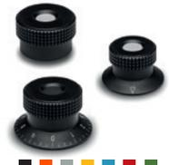
Neutra, con indice triangolare o graduazione di precisione, incisi a laser. Calottina di chiusura in tecnopolimero nei colori standard. Boccola ottone, foro cieco liscio. Fissaggio per mezzo di una vite di pressione trasversale con cava esagonale in acciaio brunito. Diametri: 30 - 40 - 50 mm
