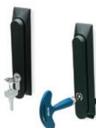
Perno maniglia in lega di zinco cromata con OR in gomma sintetica NBR; guarnizioni di tenuta in silicone e gomma NBR; viti in acciaio zincato. Esecuzioni standard: serratura con cifratura differenziata, con cifratura unica o per chiave in tecnopolimero con inserto in zama e innesto a due alette, statore di tipo europeo, esecuzione con grado di protezione IP 65. Dimensione: 160 mm
