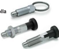
Con o senza arresto in posizione retratta. Puntale in acciaio INOX AISI 303. Manopola in tecnopolimero oppure anello in acciaio INOX. Esecuzioni standard: con o senza controdado. Puntale Ø: 3 - 4 - 5 - 6 - 8 - 10 mm
