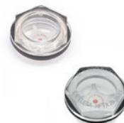
Mostrina a stella in alluminio anodizzato opaco. Rondella piana in gomma sintetica NBR. HFTX-EX sono conformi alla Direttiva Europea ATEX 2014/34/UE. Temperatura massima di esercizio in continuo: 100° C. Filettature metriche (passo 1.5): M16 - M20 - M26 - M27 - M30 - M35 - M40 Filettature GAS: 1/4 - 3/8 - 1/2 - 3/4 - 1 - 1 1/4
