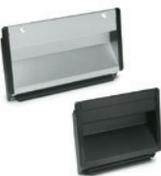
Colore naturale o nero. Chiusure laterali in tecnopolimero. Montaggio posteriore per mezzo di due profili in gomma che garantiscono un attacco fermo e sicuro, montaggio frontale per mezzo di fori passanti per viti M4 a testa svasata e profilo inferiore in gomma. Per lamiere di spessore tra 1.0 e 2.5 mm. Dimensioni: 100x90 - 118x90 - 167x90 mm
