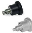
Con o senza arresto in posizione retratta. Manopola in tecnopolimero. Indicati per montaggio su lamiera di spessore sottile grazie alle loro dimensioni particolarmente ridotte. Puntale Ø: 4 - 5 - 6 - 7 - 8 - 10 mm
