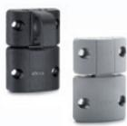
Esecuzioni standard: blocco e sblocco a scatto (BMS), blocco a scatto e leva per sblocco (BMS-L), blocco a scatto e chiave esagonale per sblocco (BMS-EH) o blocco a scatto e chiave a due alette per sblocco (BMS-A) Montaggio a mezzo di viti TCEI M4. Diametro: 38 mm
