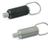
Con o senza arresto in posizione retratta. Puntale in acciaio INOX AISI 303. Anello in acciaio INOX AISI 301. Esecuzioni standard: con o senza controdado. Puntale Ø: 5 - 6 - 8 - 10 mm
