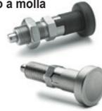
Con o senza arresto in posizione retratta. Puntale in acciaio brunito con estremità temprata o acciaio INOX AISI 303 nichelato. Con o senza manopola in tecnopolimero o acciaio INOX AISI 303. Esecuzioni standard: con o senza manopola e controdado. Puntale Ø: 5 - 6 - 8 - 10 mm
