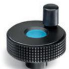
Calottina nei colori standard. Boccola in ottone, foro cieco liscio, fissaggio per mezzo di una vite di pressione trasversale. Diametri: 40 - 50 - 60 - 70 - 85 - 100 mm
