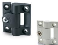
Perno di rotazione in tecnopolimero. Vite in acciaio INOX AISI 304 e boccola di regolazione in acciaio INOX AISI 303. Montaggio mediante fori passanti per viti a testa cilindrica. Angolo di rotazione: max 275° (-95° e +180° con 0° = complanarità delle superfici interconnesse). Coppia resistente max: 1.4 - 4 Nm. CFU-CLEAN in bianco simile a RAL 9002. Dimensioni: 40 - 60 mm
