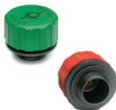
Colore rosso con guarnizione a membrana in gomma sintetica EPDM, colore verde con guarnizione a membrana in gomma sintetica FKM. Raccordo filettato colore nero. Rondella piana in EPDM (coperchio rosso) o FKM (coperchio verde). Temperatura massima di esercizio in continuo: 50° C. Filettatura GAS: 1/4
