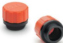
Coperchio in tecnopolimero arancio; raccordo filettato in tecnopolimero nero o attacco rapido a baionetta in acciaio zincato. Con o senza filtro d'aria in schiuma poliuretana "tech-foam". Rondella piana in gomma NBR. Temperatura massima in continuo: 100° C. Diametri: 30 - 40 - 57 - 70 mm
