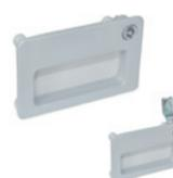
Maniglia colore nero o grigio. Esecuzioni standard: innesto chiave triangolare, quadro 7x7 o a due alette, posizionato a destra o sinistra. Montaggio a mezzo 5 viti in acciaio zincato. Levetta di chiusura GN 115 in acciaio zincato. Dimensione: 128 mm, campo di regolazione da 13 a 75 mm
