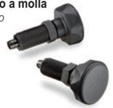
Puntale in acciaio temprato e brunito o acciaio INOX AISI 303. Manopola in tecnopolimero. Esecuzioni standard: con o senza controdado. Puntale Ø: 8 - 10 mm
