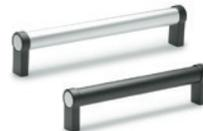
Tubo in alluminio anodizzato, naturale o con rivestimento in resina epossidica. Tappi di chiusura laterali in tecnopolimero. Supporti laterali in lega di zinco pressofusa con rivestimento in resina epossidica. Fori di montaggio ciechi filettati. Interassi di fissaggio: 180 - 200 - 300 - 400 - 500 mm
