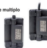
Interruttore con 4 contatti elettrici configurabili in fabbrica: normalmente aperto (NO) o normalmente chiuso (NC). Esecuzioni standard 2NO+2NC e 1NO+3NC. Apertura positiva a norma IEC EN 60947-5-1. Doppio isolamento dei circuiti interni. Omologazione UL:E360222, IMQ:CA02.04800. Dimensione: 110 mm
