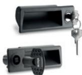
Due chiavi in ottone nichelato o tecnopolimero. Esecuzioni standard: serratura, con chiave estraibile in due posizioni, rotazione 90°, posizionata a destra o sinistra. Cifratura unica, differenziata o differenziata con chiave passe-partout oppure chiusura tipo quadri elettrici con innesto triangolare, quadrato o a due alette. Levetta di chiusura LPR in acciaio zincato o acciaio INOX. Dimensione: 117 mm
