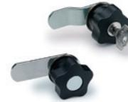
Statore e rotore in zama; ghiera in ottone; rosetta elastica, rondella di posizionamento e levetta di chiusura in acciaio zincato; due chiavi in ottone nichelato, estraibili in due posizioni a 180° (serratura aperta o chiusa). Esecuzioni standard: apertura a destra o a sinistra; serratura con cifratura differenziata, unica, differenziata e passe-partout o senza serratura. Diametro volantino: 40 mm
