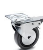
Corpo centrale in tecnopolimero. Supporto in lamiera di acciaio zincato, piastra fissa o girevole (anche con foro passante centrale o perno filettato) con o senza freno. RE.C7-G: versione con ruote gemellate.
