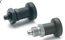
Puntale in acciaio brunito con estremità temprata o acciaio INOX AISI 303 nichelato; controdado in acciaio brunito o acciaio INOX. Manopola in tecnopolimero. Esecuzioni standard: con o senza controdado. Puntale Ø: 6 - 8 mm
