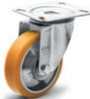
Mozzo con cuscinetti a sfere. RE.F5-N: supporto in lamiera di acciaio zincato, piastra fissa o girevole (anche con foro passante centrale) con o senza freno. RE.F5-H: supporto in lamiera di acciaio per carichi medio-pesanti, piastra fissa o girevole, con o senza freno. Ruota Ø: 80 - 100 - 125 - 150 - 200 mm
