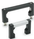
Supporti laterali in tecnopolimero e tubo in alluminio, colore naturale o nero. Montaggio posteriore, boccole filettate in acciaio zincato; montaggio frontale, fori passanti per viti a testa cilindrica in acciaio INOX e dadi autobloccanti zincati. Adatte all'impiego su rack 19".
