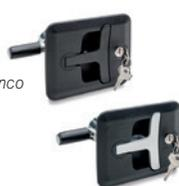
Maniglia colore nero o grigio. Esecuzioni standard: serratura a cifratura differenziata o a cifratura unica. Due chiavi in ottone nichelato estraibili in due posizioni a 90°. Montaggio a mezzo 4 viti in acciaio zincato costampate nella base. Il ribaltamento della maniglia nell'apposita sede trasla assialmente l'albero con la leva in direzione del battente fino alla posizione di blocco. Dimensione: 128 mm, campo di regolazione da 13 a 75 mm
