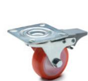
Corpo centrale in tecnopolimero. Supporto in lamiera di acciaio zincato, piastra fissa o girevole (anche con foro passante centrale o perno filettato) con o senza freno. RE.C6-G: versione con ruote gemellate.
