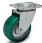
Mozzo con cuscinetti a sfere. RE.F2-N: supporto in lamiera di acciaio zincato, piastra fissa senza freno o girevole con freno. RE.F2-H: supporto in lamiera di acciaio per carichi medio-pesanti, piastra fissa senza freno o girevole con freno. RE.F2-WH: supporto in acciaio elettrosaldato per carichi pesanti, piastra fissa senza freno o girevole con freno. Ruota Ø: 100 - 125 - 160 - 200 mm
