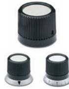
Calottina copriboccola in tecnopolimero; flangia in alluminio anodizzato opaco con indice triangolare o graduazione di precisione in colore nero, incisi a laser. Boccola acciaio brunito, foro alesato H7. Fissaggio con linguetta o spina elastica trasversale oppure per mezzo di viti a pressione. Diametri: 32 - 37 - 42 - 48 - 52 - 58 - 63 - 80 mm
