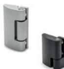
Corpi complanari o rialzati con apertura sinistra o destra. Perno di rotazione in acciaio INOX AISI 304. Bussole guida perno in tecnopolimero. Montaggio mediante viti autofilettanti in acciaio INOX. Angolo di rotazione: max 185° (-5° e +180° con 0° = complanarità delle superfici interconnesse). Dimensioni: 50 - 70 - 90 mm
