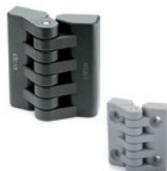
Perno di rotazione in acciaio INOX AISI 303 o tecnopolimero (CFAx). Montaggio mediante boccole ottone nichelato, foro filettato; prigionieri filettati in acciaio nichelato; fori e asole (CFA-SL) passanti per viti a testa cilindrica. Angolo di rotazione max 215° (-35° e +180° con 0° = complanarità delle superfici). Dimensioni: 40 - 49 - 65 - 97 mm
