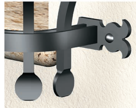
Esempio di fissaggio trasversali di inferriata sporgente
